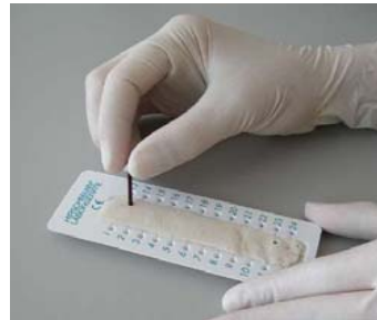
Kapillare mit Wachs versiegeln
